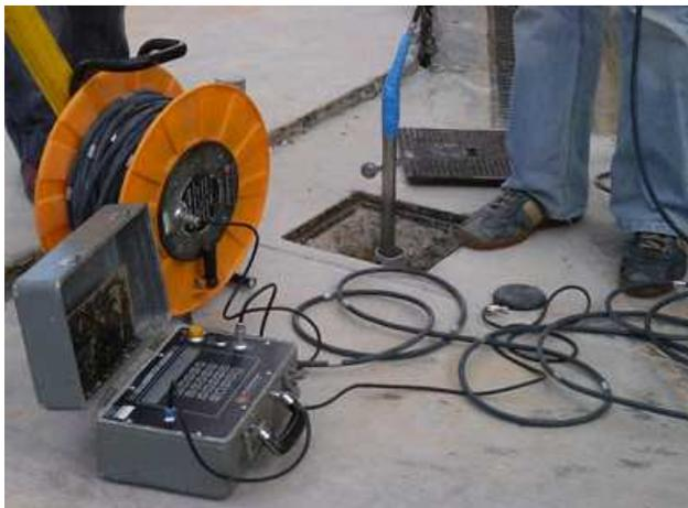
Varios clientes han puesto su confianza en nosotros para realizar instrumentación geotécnica en sus obras. Las medidas inclinométricas en varios sondeos verticales han servido para el control de movimientos horizontales en un muro de suelo reforzado con geomalla.
