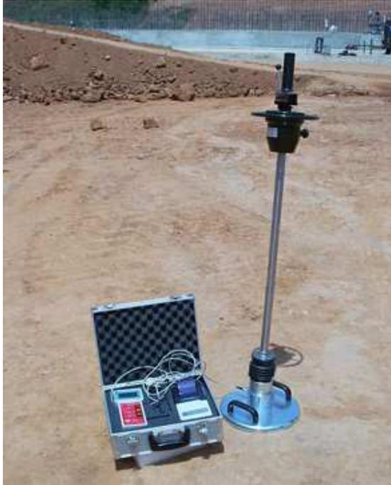
CFT&Asoc, S.L. tiene la representación exclusiva para España de la distribución del equipo ligero para ensayo dinámico de carga con placa HMP-LFG, del fabricante alemán HMP. Mediante dicho equipo se puede obtener en obra el módulo de deformación dinámica de capas compactadas de terraplenes y bases granulares, de manera prácticamente instantánea y sin necesidad de utilizar camiones u otros elementos como reacción.
