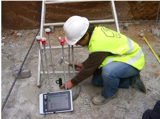
En los ensayos sónicos se utiliza un martillo de mano para generar una onda sónica en la cabeza del pilote o por discontinuidades o defectos existentes en el mismo. La onda es captada por un acelerómetro y enviada a un procesador portátil que permite visualizar inmediatamente en obra las gráficas e imprimirlas posteriormente.
