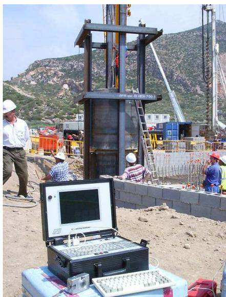
En el **ensayo dinámico de carga** se utiliza una maza que cae e impacta sobre el pilote para moviliza su resistencia por punta y por fuste, y mediante instrumentación electrónica captar su comportamiento y obtener después por cálculo numérico la capacidad portante del pilote. Hemos realizado una prueba dinámica de carga sobre un pilote perforado de 1,25 m de diámetro en Cartagena. Mediante esta prueba se obtuvo la capacidad última del pilote y la curva de carga-asiento en condiciones estáticas.
