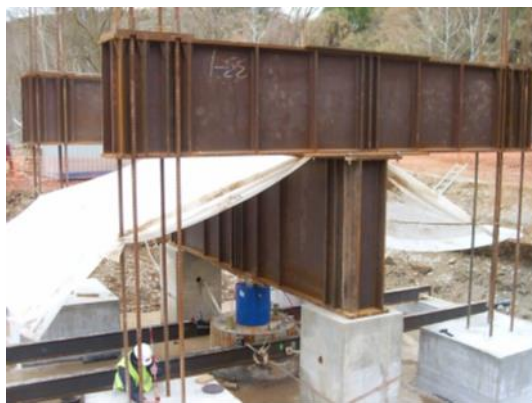
Figura 3. Dispositivo para una prueba SLT de 10 MN (1000 t) (fuente: propia)
