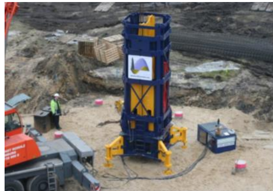
Figura 9. Vista de conjunto de un equipo StatRapid (fuente: Moscoso, N. y otros, 2019)
