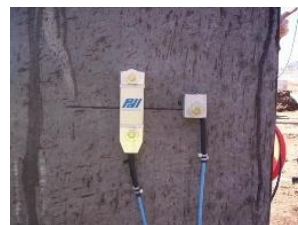
Figura 8. Sensores de medida de fuerza y velocidad en una prueba dinámica (fuente: propia)
