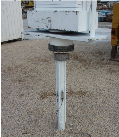
Foto 1. Martillo de golpeo y micropilote con instrumentación.
