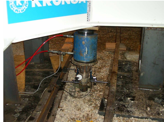
Foto 2. Gato hidráulico y bastidor de reacción.
