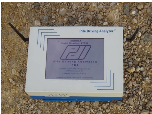
Figura 16. Analizador de hinca de pilotes. Modelo PAX (Pile Dynamics, Inc)
