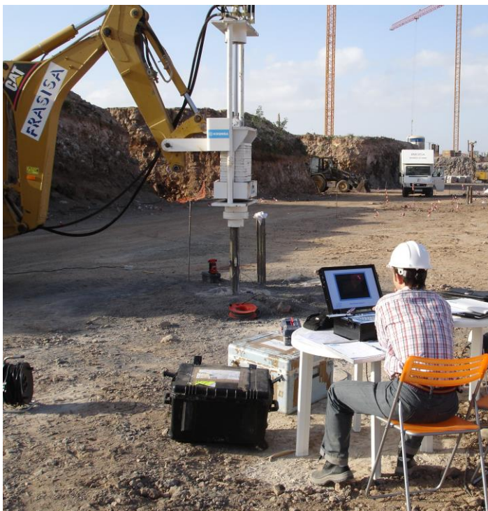
Figura 26. Prueba de carga dinámica sobre micropilote (RK)
