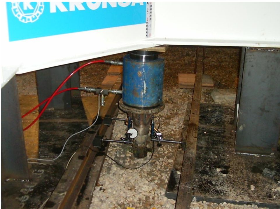
Figura 24. Prueba de carga estática sobre micropilote (RK)
