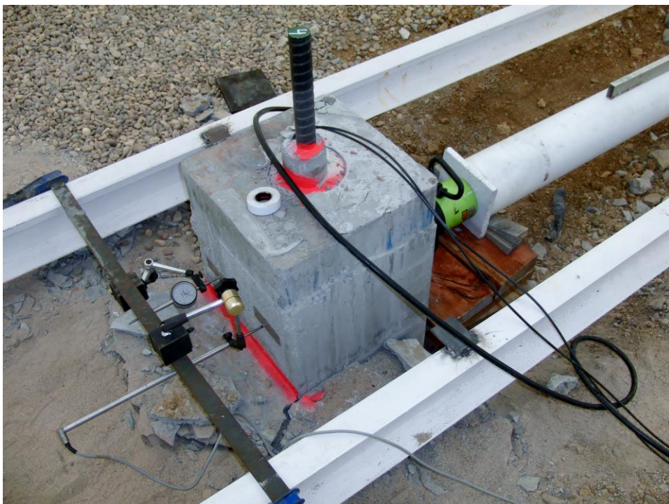
Figura 12. Instrumentación de prueba de carga lateral (RK)
