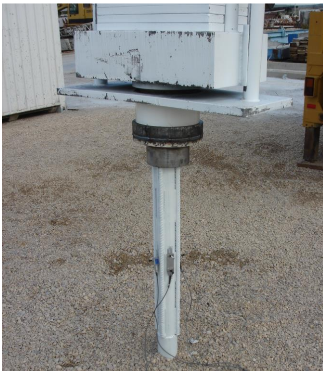
Figura 22. Martillo e instrumentación en el micropilote (RK)
