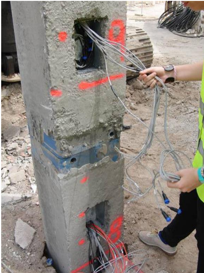
Figura 6. Instrumentación pilote prefabricado en proyecto PITERM (RK)
