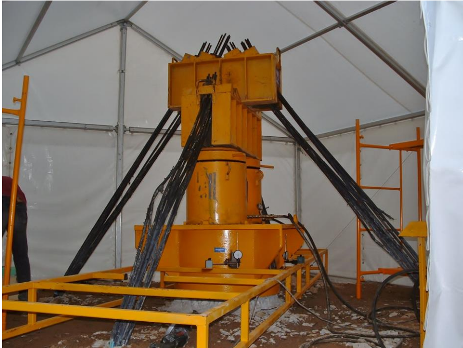
Figura 4. Reacción mediante anclajes al terreno (Terratest).
