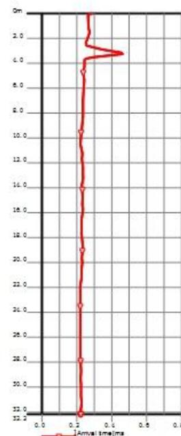
Figura 7: Anomalía en ensayo ultrasónico
