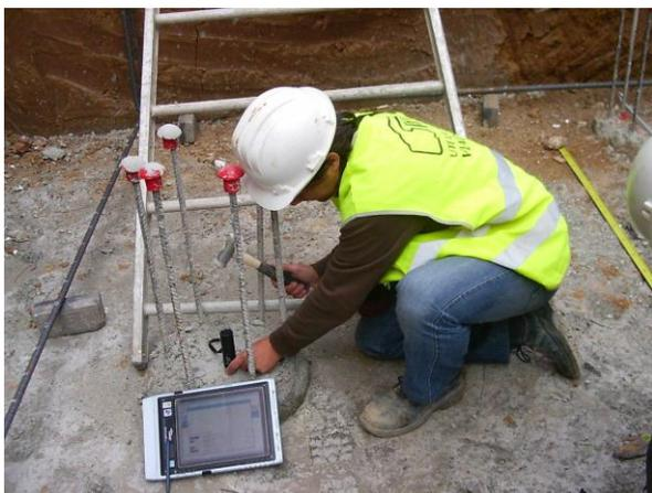
Figura 1. Ensayo sónico de un pilote
