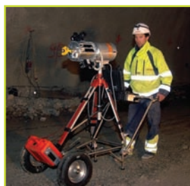
Escáner láser Dibit en el interior de un túnel en construcción
