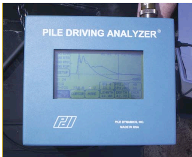
5. Equipo analizador de hinca.
