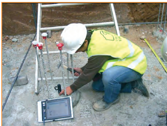
■ [Fig. 1].- Ensayo sónico de un pilote.
