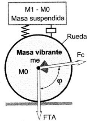
Figura 7. Esquema de funcionamiento de la rueda vibratoria
