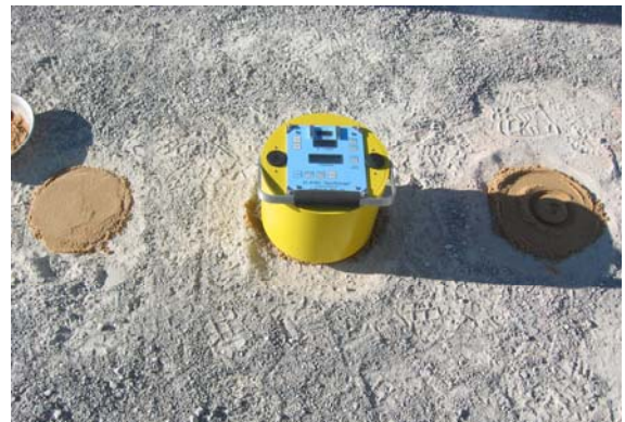
Foto 4.- Realización del ensayo con el geogauge
