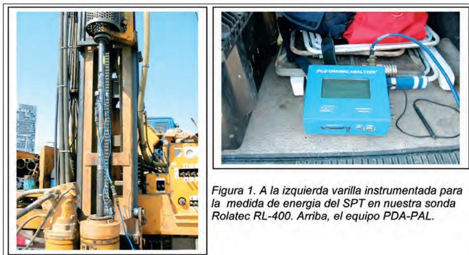
Figura 1. A la izquierda varilla instrumentada para la medida de energía del SPT en nuestra sonda Rolatec RL-400. Arriba, el equipo PDA-PAL.
